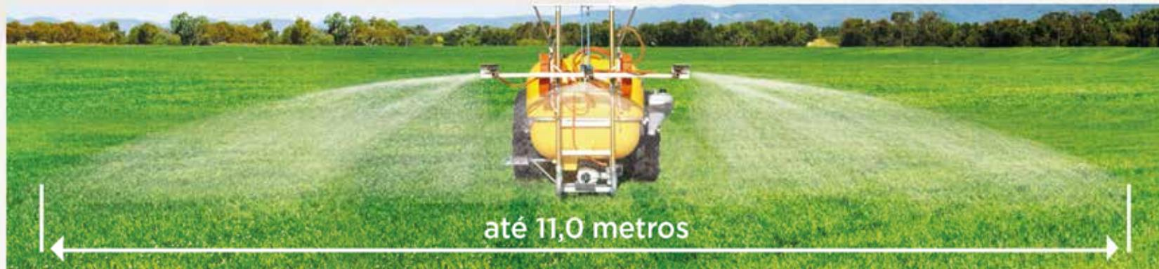
A versão standard de todos os modelos já oferece comando de pulverização com 1 via específica para cada bico, reabastecedor e lavador de embalagem na boca do tanque (modelos de 3 pontos). E no modelo KO 2000 Pecuária, há o incorporador de produtos com lavador de embalagens (KO Mix).
